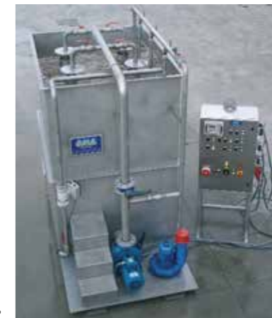
Пилотная установка MBBR и FBFR
