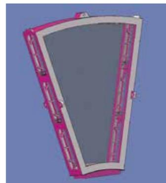
Фильтрующие элементы представлены плетеной полиэстерной тканью, зафиксированной на прочной раме из армированного полипропилена с помощью термической сварки. Каждый одиночный фильтрующий элемент может быть извлечен и легко заменен благодаря специально разработанной системе фиксации, сам процесс замены занимает минимальное время и не требует опорожнения емкости фильтра.
