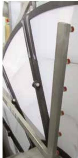
Промывка фильтровальной ткани осуществляется с помощью ножевых форсунок, которые расположены между дисками. На форсунки при помощи насоса подается часть отфильтрованной самим фильтром воды, что позволяет отказаться от потребления свежей воды.
