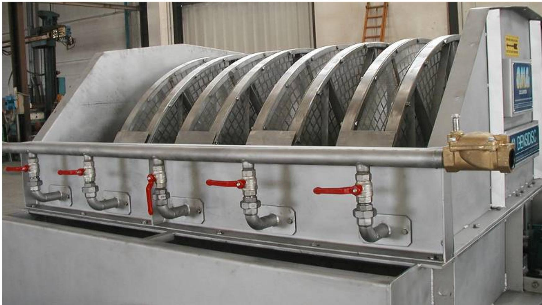
Промывная система фильтрующей сетки
