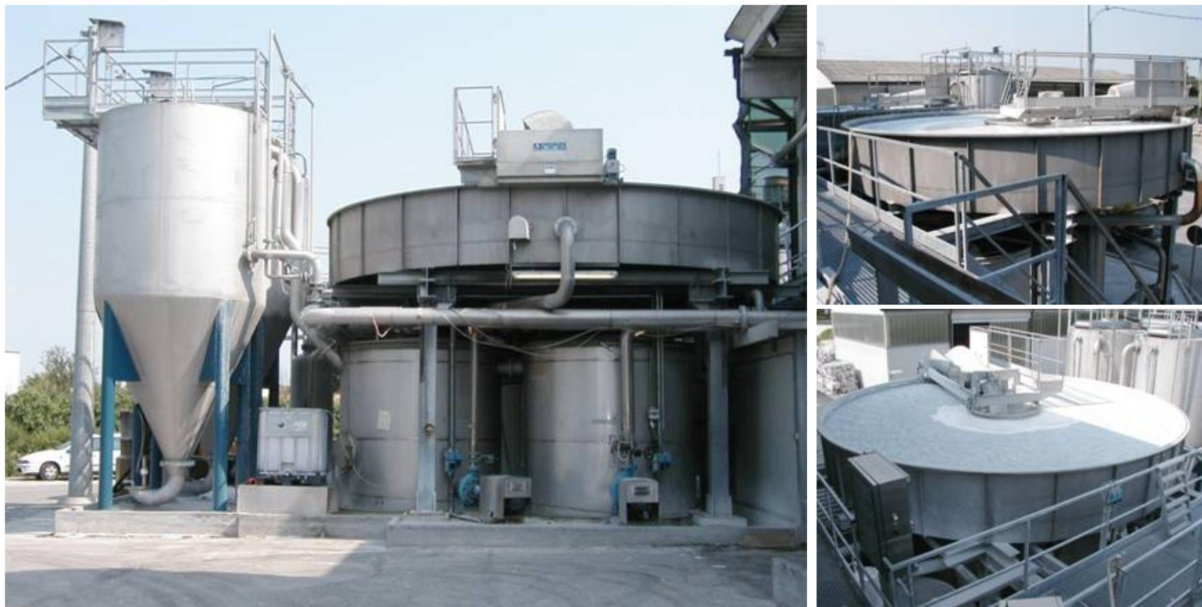
**2 флотатора DELTAFLOAT 42 и 2 фильтра OMEGAFILTER на бумажной фабрике, Италия**
