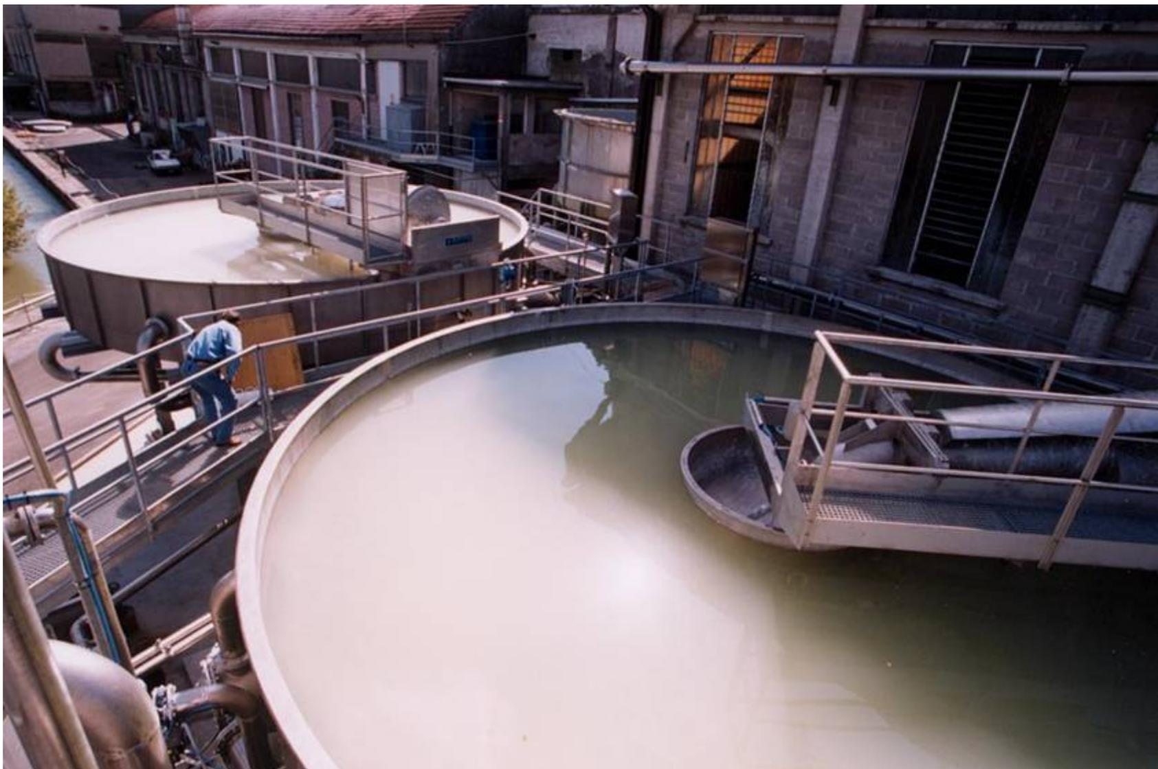
**2 флотатора DELTAFLOAT 42 и 2 фильтра OMEGAFILTER на бумажной фабрике, Италия**
