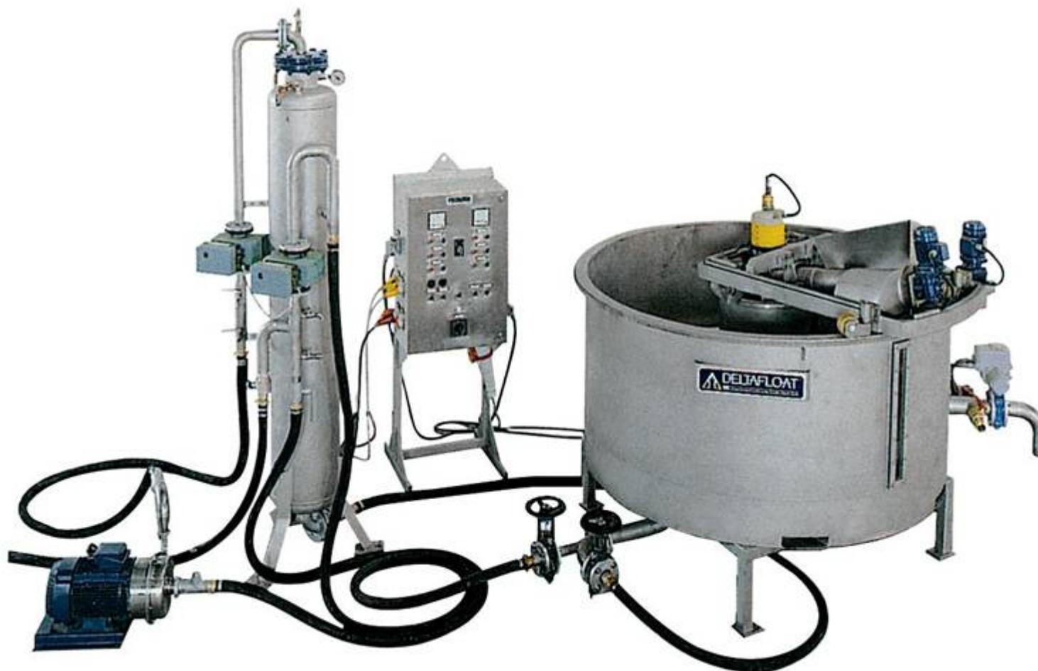
**Испытательная флотационная установка**
