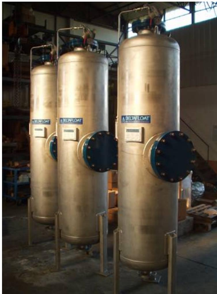
Гидродинамические реакторы насыщения A.S.R. Со смотровыми окнами, изготовленные в соответствии с требованиями стран СНГ.
