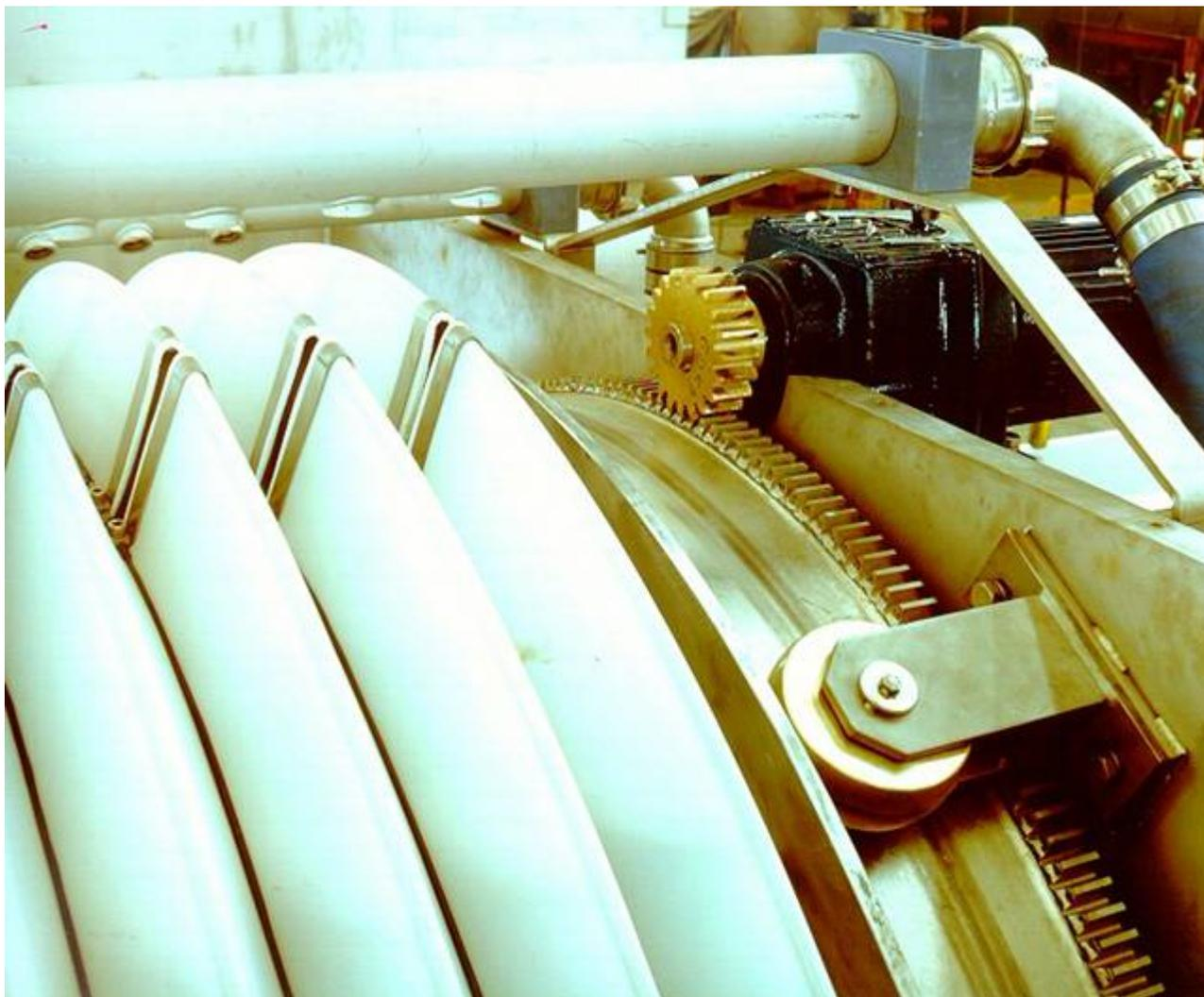
**Движение барабана осуществляется с помощью системы зубчатая рейка – шестерня, исключая эффект проскальзывания.**
